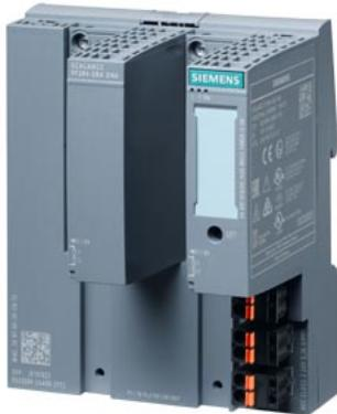
SCALANCE XF204-2BA DNA промышленный управляемый IE Y-коммутатор, 4x электрических RJ45 порта 10/100 Мбит/с, 2x порта для шинных адаптеров, диагностический выход с кнопкой сброса ошибок, резервированное питание 24В постоянного тока, PROFINET-устройство, расширенный температурный диапазон (от -40°C до +70°C), конформное покрытие, электронное руководство на DVD, поддержка C-plug модуля (приобретается отдельно), поставляется без шинных адаптеров.
