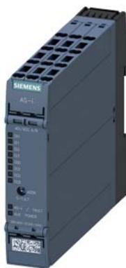
Модуль AS-i SlimLine Compact SC22.5, цифровой, A/B-подчиненный компонент 4 ЦВх/4 ЦВх, IP20 4 x вход для 3-проводного датчика Питание датчика с возможностью переключения 4 x выход, 2 A, 24 В DC макс. 4 A на все выходы пружинные клеммы Установочная ширина 22,5 мм
