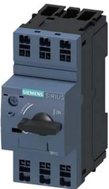
Автоматический выключатель, типоразмер S00 для защиты трансформатора. Максимальный расцепитель тока с обратнозависимой выдержкой времени 1,8–2,5 A. N-расцепитель 52 A. Подключение на пружинных клеммах. Стандартная коммутационная способность.
