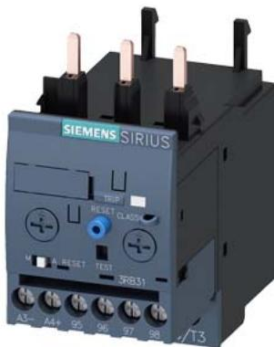
Реле перегрузки 1–4 А электронн. для защиты двигателя Типоразмер S0, класс 5–30 Для установки на контакторах Главная цепь: винт Вспомогательная цепь: винт Ручной/автоматический сброс Внутреннее обнаружение замыкания на землю
