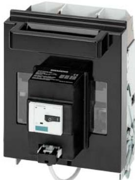
SENTRON, предохранитель-разъединитель 3NP5, 3-пол., NH1, 250 A, для поверхностного и внутреннего монтажа на монтажной панели, в т. ч. устройство быстрого включения, винтовые зажимы, устр. контроля предохранителей: посредством 3RV, доп. контакты на выключателе-разъединителе: 1 НО + 1 НЗ, доп. контакты на устр. контроля предохранителей: 1 НО + 1 НЗ
