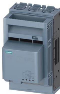
SENTRON, предохранитель-разъединитель 3NP1, 3-пол., NH00, 160 A, для поверхностного и внутреннего монтажа на монтажной панели, плоский контакт, устр. контроля предохранителей: электронное устройство EFM 10, плоскость крышки 45 мм
