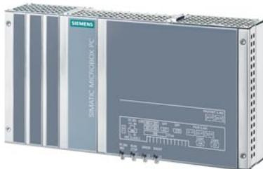
SIPLUS IPC427E, с конформным покрытием, на основе 6AG4141-5BG34-0FA0 . Microbox PC, встроенная HD-графика, 4x USB V3.0 (высокий ток), PCIe (опционально), питание =24 В, Core i5-6442EQ; 3x Gbit Ethernet (IE/PN); монтаж на стандартную DIN-рейку; 8 GB и NVRAM; 2x RS232, без PCIe; Windows 7 Ultimate SP1, 64-битная MUI (de, en, es, fr, it); без сменных носителей, твердотельный SSD-накопитель 240 GB SATA; без ПО SIMATIC;
