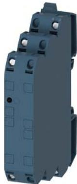
Разделительный преобразователь 24–240 В AC/DC, 3-канальное разделение Вход: 0–10 В, 0/4–20 мА Выход: 0–50/100 Гц/1/10 кГц
