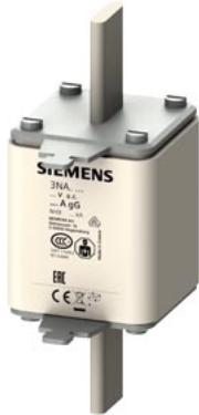
вставка предохранителя NH, NH3, In: 250 A, gG, Un AC: 500 B, Un DC: 440 B, фронт. индикат., токопроводящие монт. выступы
