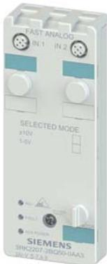
Компактный модуль AS-i K60, аналоговый А/В-подчиненный компонент, 2 АВх, IP67 2 х вход, Напряжение +/- 10 В 1–5 В для 4-проводных датчиков 2 х розетка M12 Монтажная панель 3RK1901-0CA00 заказывается отдельно
