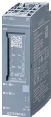
SIMATIC ET 200SP, коммуникационный модуль CM 1x DALI, мастер-модуль интерфейса DALI, интегрированное питание шины DALI 160 mA, до 64 механизмов управления DALI, 63 управляемых устройства, цветовой код CC20, для установки на базовый блок BU типа U0
