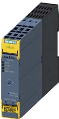
Реверсивный пускатель Failsafe, 3RM1, 500 В, 0–0,12 кВт, 0,1–0,5 А, 24 В DC, подключение на пружинных клеммах
