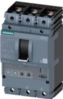
авт. выключатель 3VA2 IEC типоразм. 250 класс коммутационной способности H  $I_{cu} = 85 \text{ kA} @ 415 \text{ В}$  3-пол., защита оборудования ETU350, LSI,  $I_{n} = 250 \text{ А}$  защита от перегрузки  $I_{tr} = 100 \dots 250 \text{ А}$  защита от коротких замыканий  $I_{sd} = 1,5 \dots 10 \times I_{tr}$ ,  $I_{li} = 10 \times I_{n}$  плоский винтовой зажим
