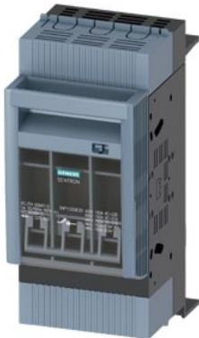
SENTRON, предохранитель-разъединитель 3NP1, 3-пол., NH000, 160 A, для систем сборных шин 8US 60 мм, рамочн. клемм., плоскость крышки 32/70 мм
