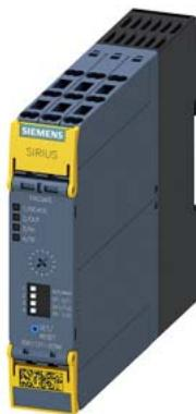
Предохранительное устройство SIRIUS Базовое устройство серии Advanced с задержкой 5–300 с Размыкающие цепи реле 2 НО, без задержки 2 НО, с задержкой  $U_s = 24$  В DC Пружинная клемма (Push-In)
