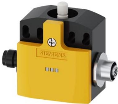
Базовый выключатель без приводной головки Пластмассовый корпус 50 мм шириной ASI-safe встроено Состояние AS-i: 1:F-IN1, 2:F-IN2 3:AS-i/FAULT Контакты зависимого действия 1 Н3 со штекером M12 4-пол. Канал 1 на Н3, канал 2 на гнездовой контакт M12 справа
