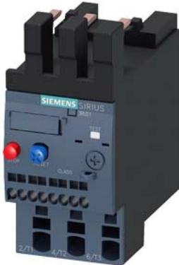
Реле перегрузки 2,2–3,2 А теплов. для защиты двигателя типоразмер S0, класс 10 Для установки на контакторах Главная цепь: пружинная клемма Вспомогательная цепь: пружинная клемма Ручной/автоматический сброс
