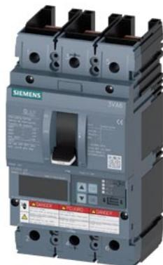
авт. выключатель 3VA6 UL типоразм. 150 класс коммутационной способности H 65 кА @ 480 В 3-пол., защита оборудования ETU550, LSI, In = 100 А защита от перегрузки, для 100% нагрузки Ir = 40...100 А защита от коротких замыканий I<sub>sd</sub> = 0,6...10 x In, I<sub>i</sub> = 1,5...12 x In защита нейтрали опционально: внешний трансформатор тока, до 160% без выводов
