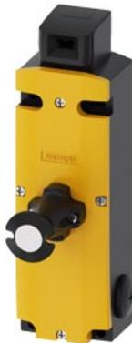
Позиционный выключатель безопасности с удерживающим устройством Усилие нажатия 2600 Н 5 направлений подвода С пружинным фиксатором Аварийное разблокирование спереди Напряжение магнита 115 В AC Контроль исполнительного механизма 2 НЗ/1 НО Контроль электромагнита 2 НЗ/1 НО Поставка без исполнительного механизма. Исполнительный механизм 3SE5000-0AV0. заказывается отдельно
