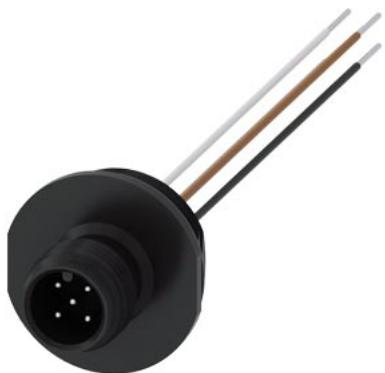
Принадлежности для позиционного выключателя Розетка прибора (5-полюсн.), M12, для M20 x 1,5 на 125 В, 4 А на штырьковый вывод 5 один желтый/зеленый провод для PE
